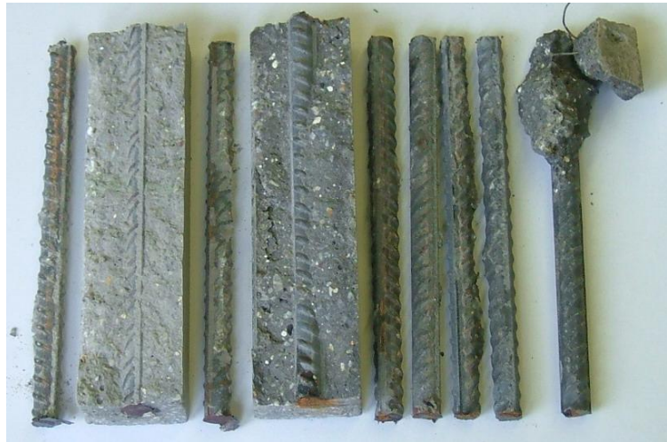
Cementbeton ágyazatú betonacélok
