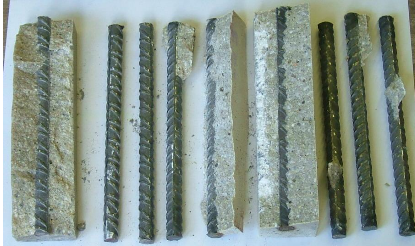
Polimer- beton ágyazatú beton- acélok
